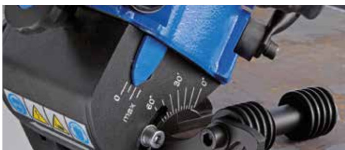
Плавная регулировка угла от 15° до 60°.
