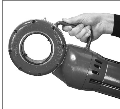
Şek. 1 700PD Şek. 2 R12+ Drophead'in Takılması.
