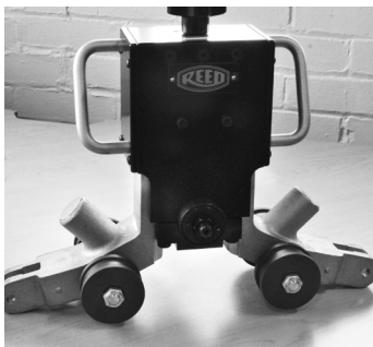
1. Empezar con la unidad base del motor 1. Commencez avec le bloc moteur de base
